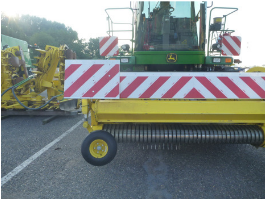
Bild 31 Seitliche Markierungsbleche zur Anpassung an die Fahrzeugumrisse verschiebbar
