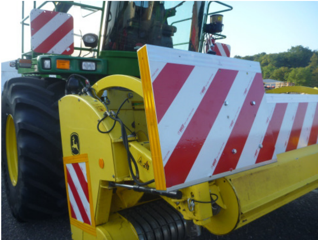
Bild 31 Seitliche Markierungsbleche zur Anpassung an die Fahrzeugumrisse verschiebbar
