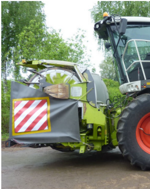
Bild 26 Selbstfahrender Feldhäcksler mit Maisvorsatzgerät (Seitenansicht)
