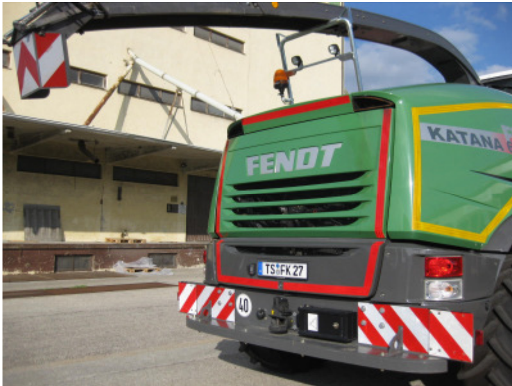
Bild 24 b Seitliche und Heckkennzeichnung (gelbe und rote Reflexionsfolie)
