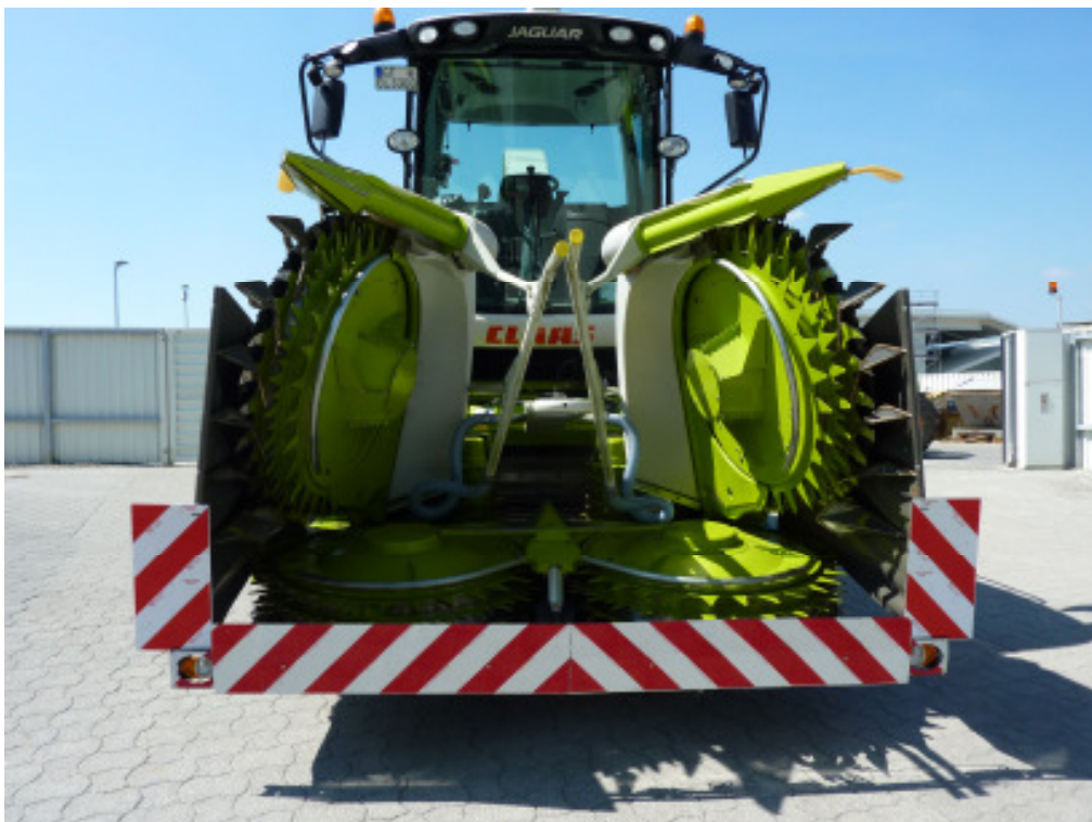
Bild 27 Selbstfahrender Feldhäcksler mit Maisvorsatzgerät (bis 8-reihig)
