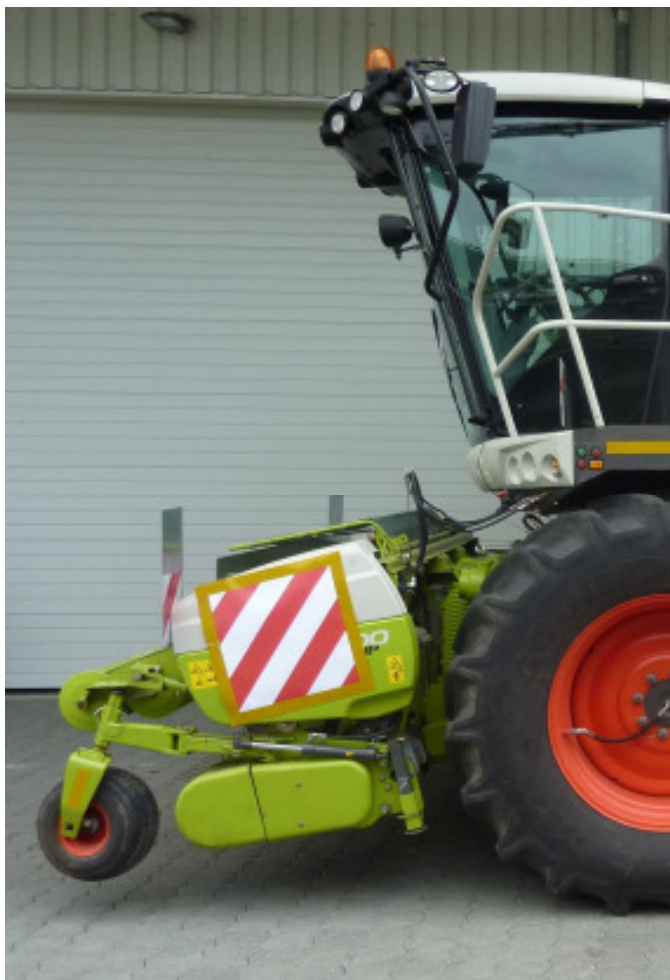
Bild 25 Feldhäcksler mit Pickup-Vorsatzgerät (Seitenansicht)
