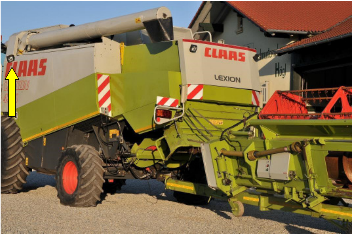
Bild 13 (Scheinwerfer links zur Ausleuchtung der Gegenfahrbahn)
