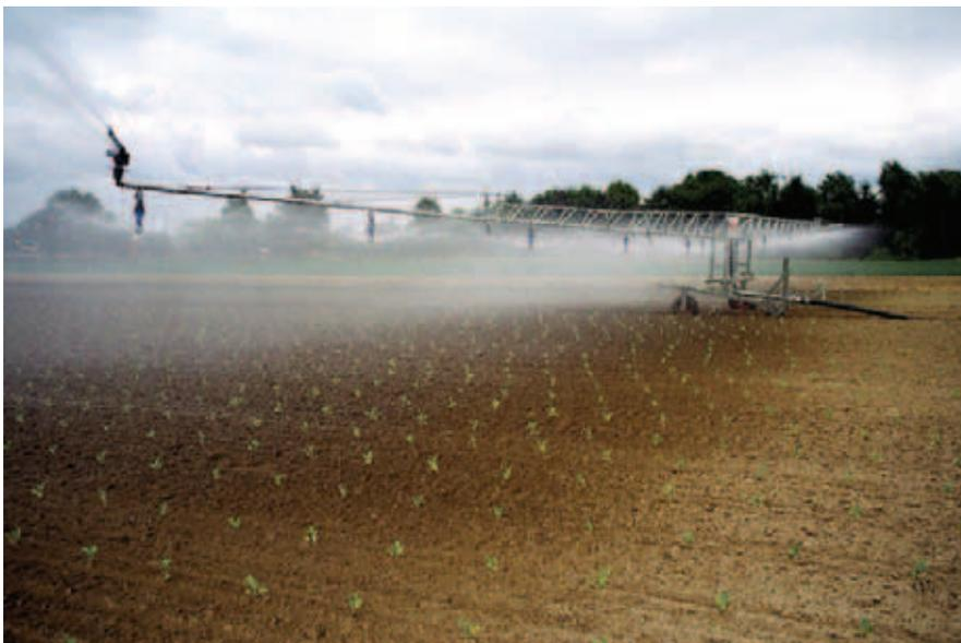
Abb. 11: Düsenwagen für Beregnungsmaschine (Foto: BEINLICH)
