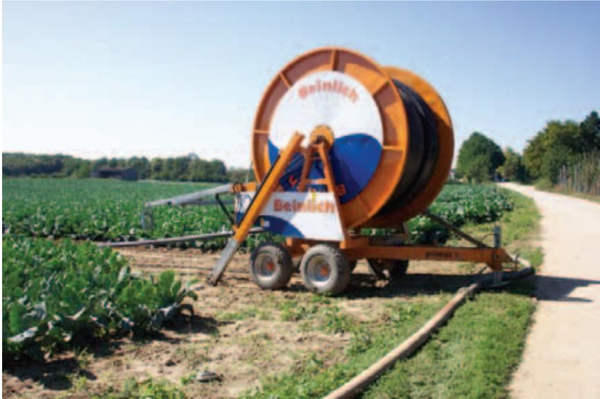
Abb. 10: Mobile Beregnungsmaschine (Einzugregner) (Foto: BEINLICH)
