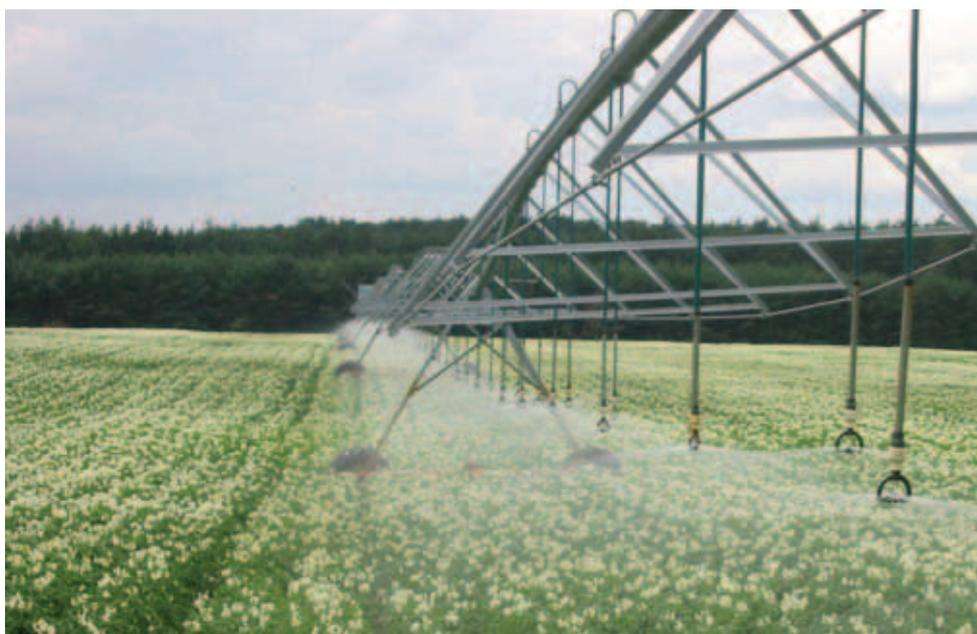
Abb. 9: Kreisberegnungsmaschine „Center Pivot“ (Foto: BAUER)
